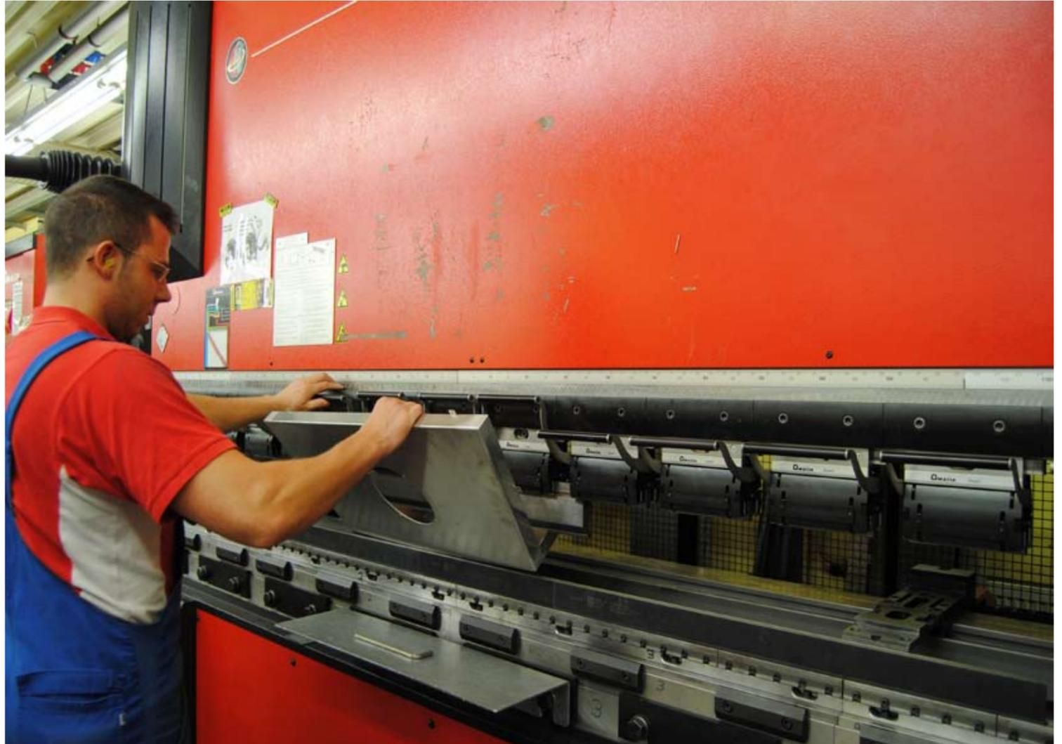
Gehäuseteil Small Chamber Type auf der Biegebank /Component of Small Chamber Type at Bent Bench
