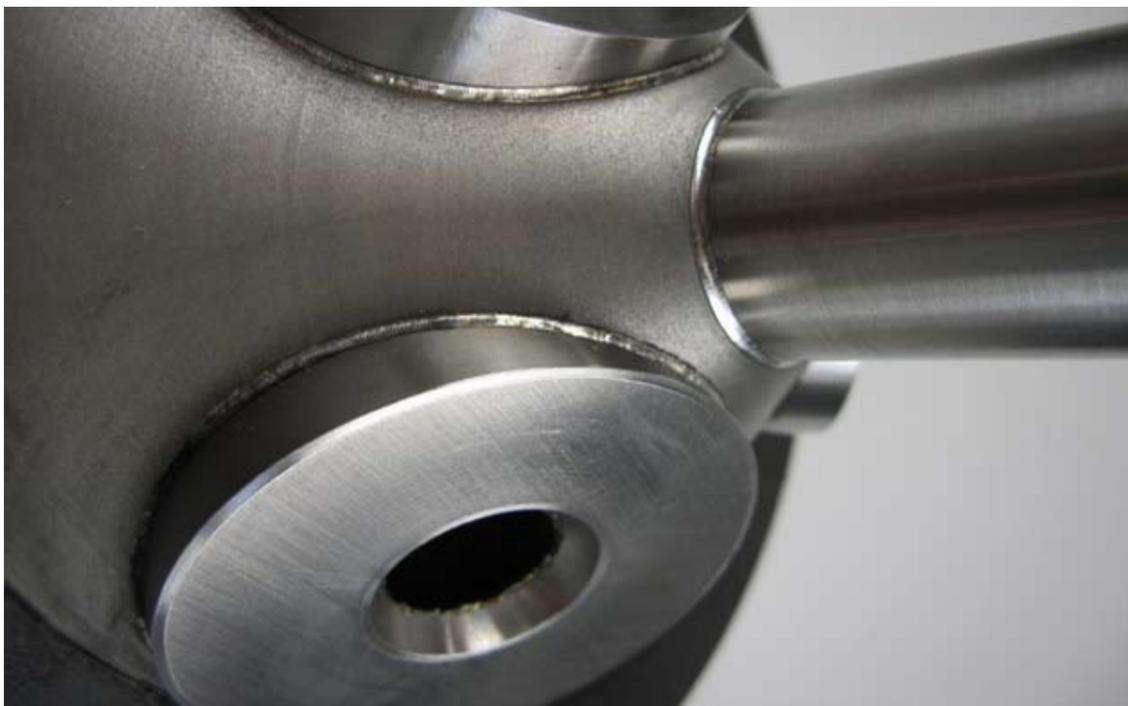
Auftragschweißung: Diagnosewerkzeug / job shop: diagnostic tool
